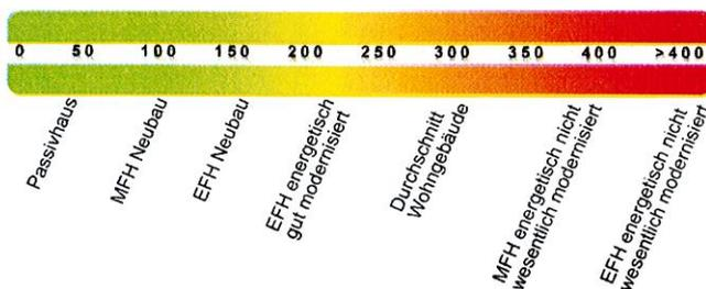
Die modellhaft ermittelten Vergleichswerte beziehen sich auf Gebäude, in denen die Wärme für Heizung und Warmwasser durch Heizkessel im Gebäude bereitgestellt wird.
